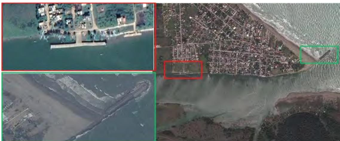
Figura 10. Obras costeras en la costa del municipio de Tecolutla: En el cuadro verde se muestra el aspecto de la escollera ubicada en la desembocadura del río Tecolutla en el año 2014. En el cuadro rojo se muestra el muelle del lado norte del río Tecolutla.
