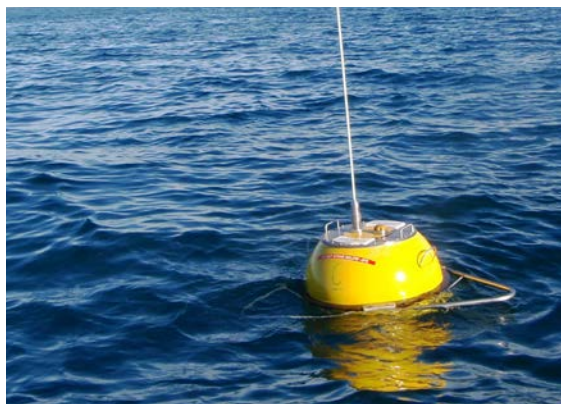
Boya de la Red nacional de estaciones oceanográficas y meteorológicas instalada. Fotografía: Instituto Mexicano del Transporte. https://www.gob.mx
