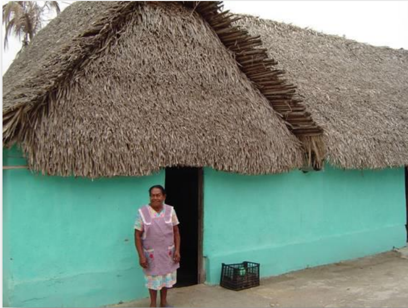
Figura 4. Señora en su casita de la costa veracruzana, elaborada con diferentes materiales naturales. El techo está construido con hojas de la palma de coyol real y las paredes con el tallo de la palma real, cubierto con adobe y pintura (verde). Fotografía R.M. González Marín.
